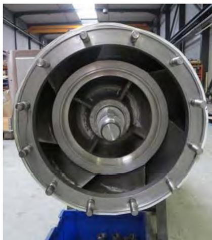
**Симметричный направляющий аппарат (диффузор)**
