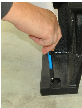
Fig. 8a Marquer les trous de perçage
