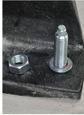
Fig. 9c Positionner la rondelle
