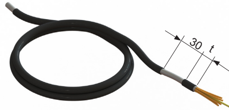
Imaginea 25 Înainte de a-l conecta la regleta de conexiuni, îndepărtați izolația cablului CEM pe 30 mm. Dimensiunea „t” corespunde aproximativ distanței dintre brățara de fixare și borna cablului
